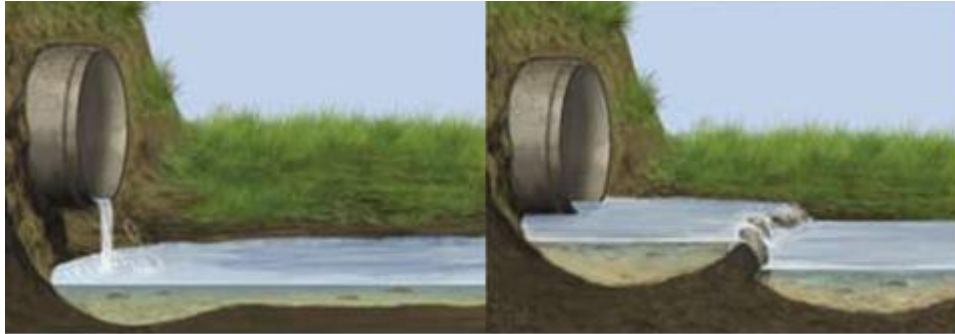
Kuva 4. Kynnistyksen avulla voidaan poistaa kalojen ja muiden vesieläinten vaelluseste. (Kuva: Lemetti 2008, 35.)
