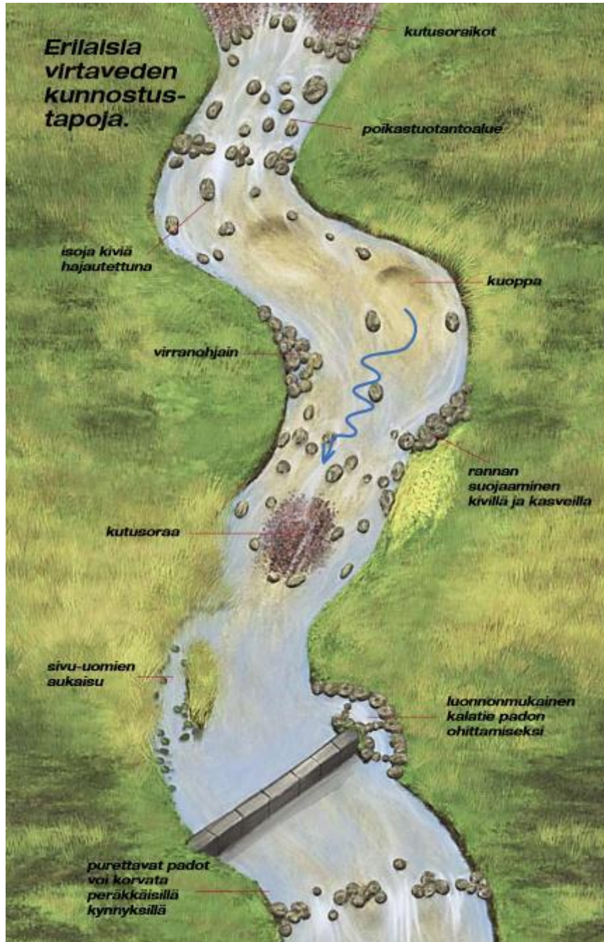
Kuva 3. Erilaisia tapoja kunnostaa kivin purouomaa. (Kuva: Lemetti 2008, 27.)
